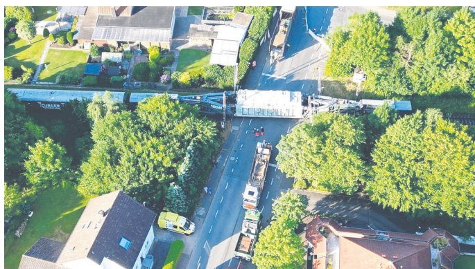
Blick aus der Vogelperspektive auf die Hauptstraße in Asemissen im Bereich des Bahnübergangs. Umladung eines riesigen Transformators von den Gleisen auf die Straße. Fotos:© Oliver Bürger
